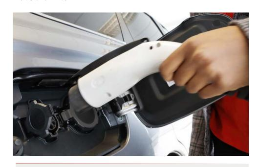
我們還可以根據直流電充電樁的電動車傳導充電系統標準進行測試,包括 BS EN IEC 61851-25:2021 和 BS EN 61851-23:2014
