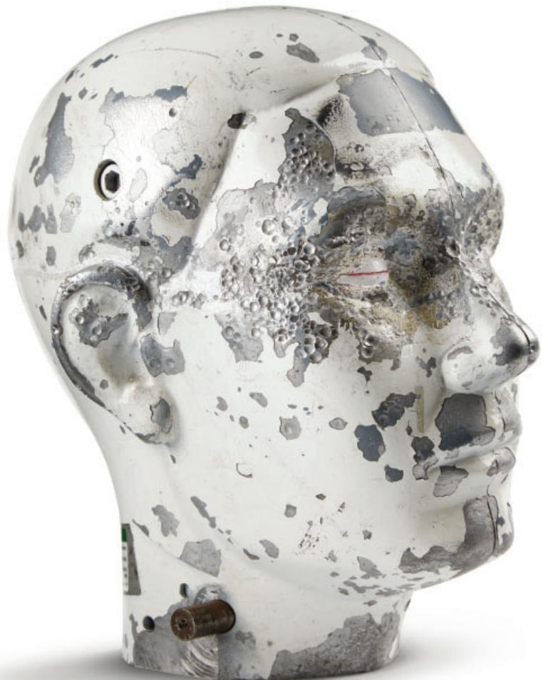
Um Schutzbrillen zu testen, feuern wir ein 6mm Kugellager mit bis zu 190 m/s auf eine solche Kopfform. So gewährleisten wir, dass auch in den gefährlichsten Umgebungen die Augen des Trägers geschützt sind.
