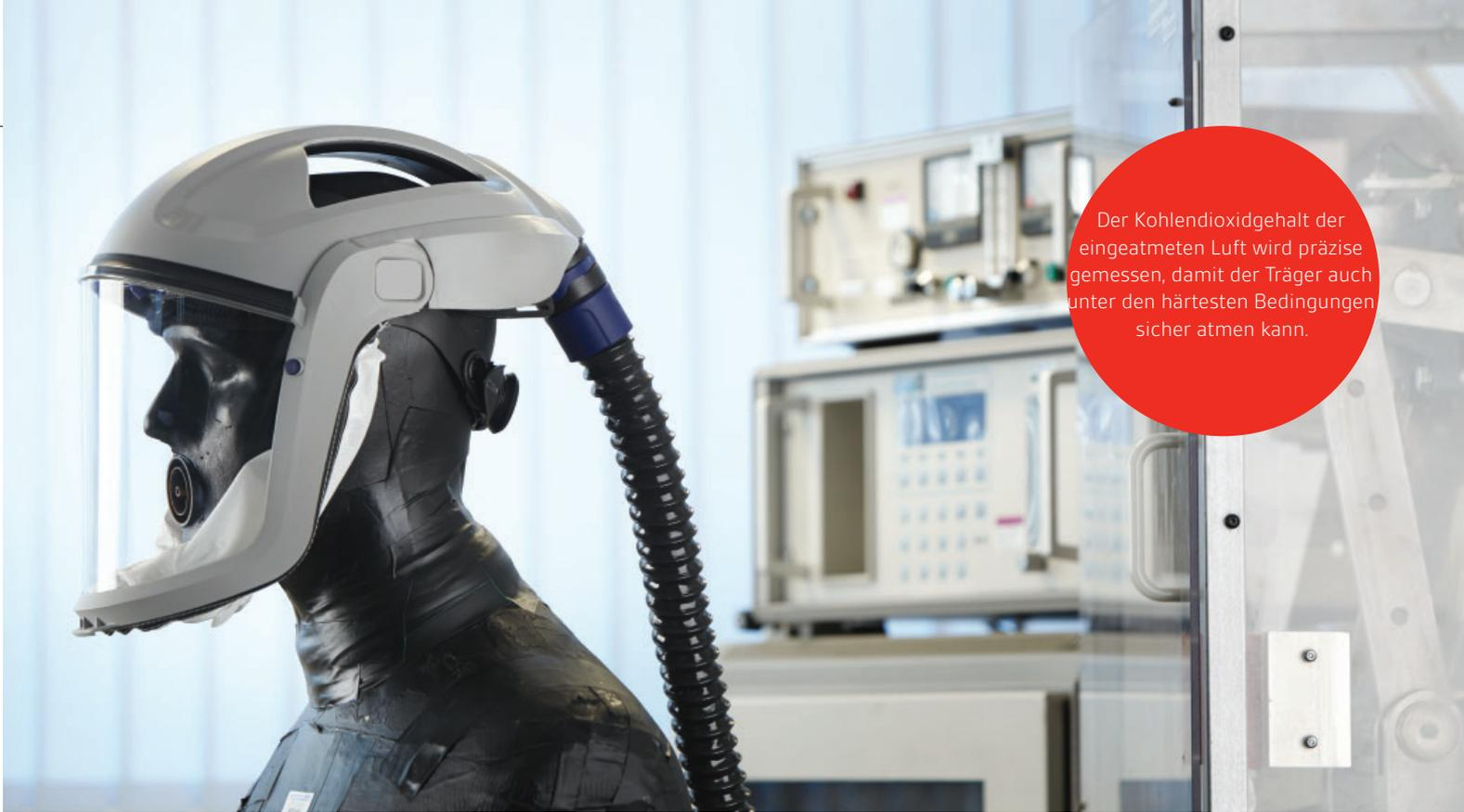
Der Kohlendioxidgehalt der eingeatmeten Luft wird präzise gemessen, damit der Träger auch unter den härtesten Bedingungen sicher atmen kann.
