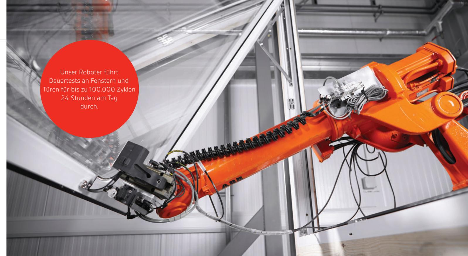
Unser Roboter führt Dauertests an Fenstern und Türen für bis zu 100.000 Zyklen 24 Stunden am Tag durch.
