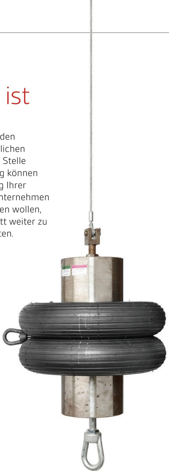
Der Pendelschlagversuch stellt sicher, dass gehärtetes und laminiertes Glas glatt bricht und schwere Verletzungen wie Schnitt- und Stichwunden verhindert werden.
